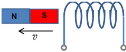
6. Определить направление индукционного тока в катушке, от которой удаляется магнит так, как показано на рис 5.
